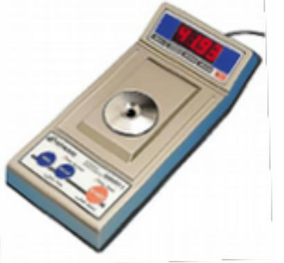
Автоматический рефрактометр DD-7 предназначен для измерения растворов имеющих низкую концентрацию, до 2% Brix, с очень высоким уровнем точности. Для измерения необходимо иметь два образца: раствор сравнения и сам образец, который нужно измерить.
